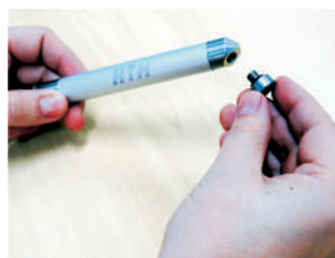
3) Conecte a ponteira diamantada na caneta.
